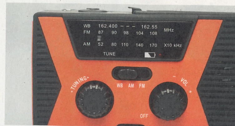
Die meisten Notfallradios enthalten einen UKW- und einen Mittelwellenbereich, manche auch den hier nutzlosen NOAA-Warnfunk, in der oberen Skala mit WB benannt.
