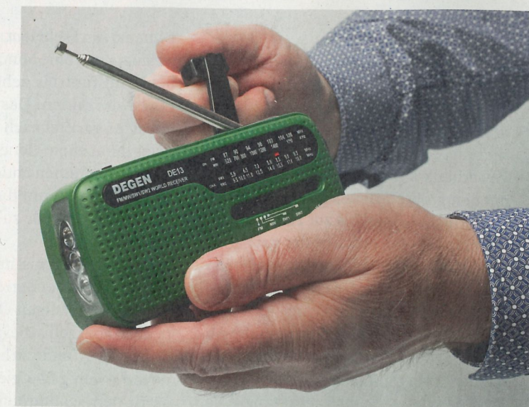
Mit Kurbeldrehungen lädt man das Radio auf, wenn der Akku leer ist. Ganz mühelos ist die Kurbel aber nicht.
